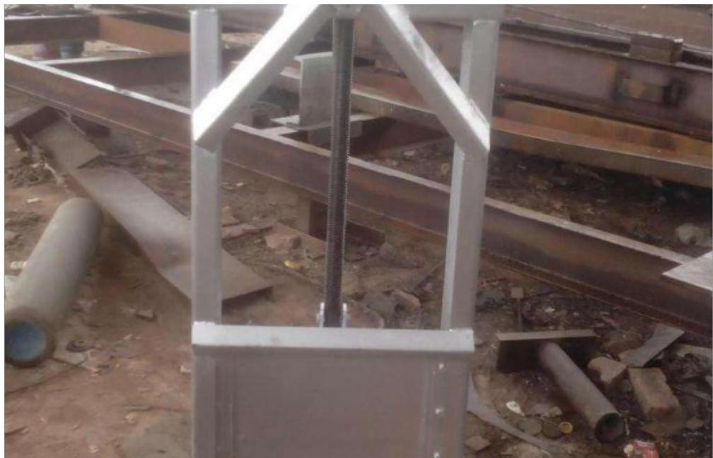
我们将水利闸门进行如下分类：1、如果按闸门的工作性质可分为工作闸门、检修闸门和事故闸门。2、如果按闸门关闭时门顶与水面的相对位置分为露顶式闸门和潜孔式闸门。3、当我们按闸门门叶的外观形状分为平面闸门、弧形闸门、人字闸门、拱形闸门、球形闸门和圆筒闸门等。4、按制造闸门门叶的材料分为钢闸门、铸造闸门、木闸门、钢筋混凝土闸门和组合材料闸门。对于翻板闸门可借助水力自动启闭，称为水力自动闸门。闸门是装于溢流坝、岸边溢洪道、泄水孔、水工隧洞和水闸等建筑物的空口上，用以调节流量，控制上、下游水位、宣泄洪水、排除泥沙或漂浮物等，是水工建筑物的重要组成部分。在水闸工程中，闸门是主体部分，常占挡水面积的大部。闸门又分为平板闸门和弧形闸门。
